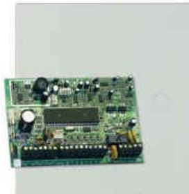
sl.1 Alarmna centrala
